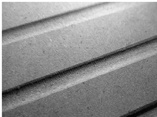
Rys. 4. Falistość powierzchni po frezowaniu Fig. 4. Waviness of the surface after milling
