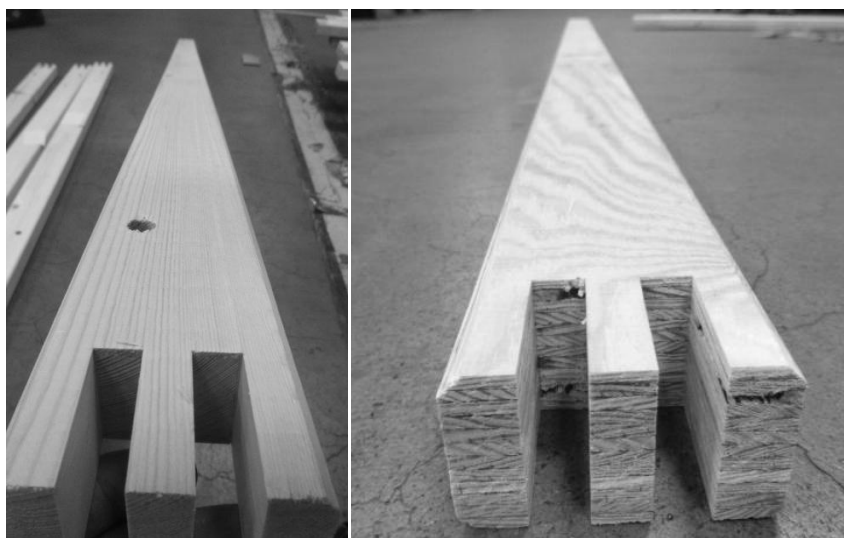
Rys. 2. Próbki badawcze: po lewej belka z tarcicy iglastej, po prawej belka z LVL Fig. 2. Samples for tests: from left pine wood, on the right LVL
