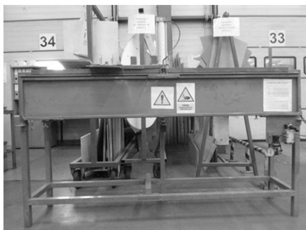
Rys. 3. Urządzenie do badań wytrzymałości na zginanie (źródło: [4]) Fig. 3. Testing machine for bending measurements
