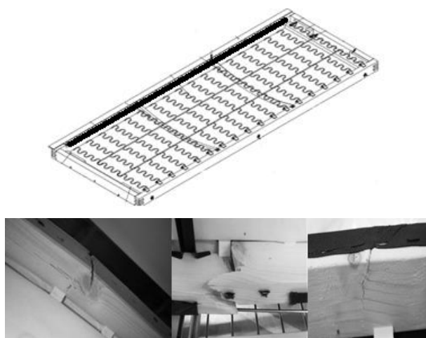
Rys. 1. Umieszczenie badanej tylnej belki w ramie tapicerskiej (zaznaczono kolorem pogrubionym czarnym) oraz przykładowe obrazy zniszczeń
