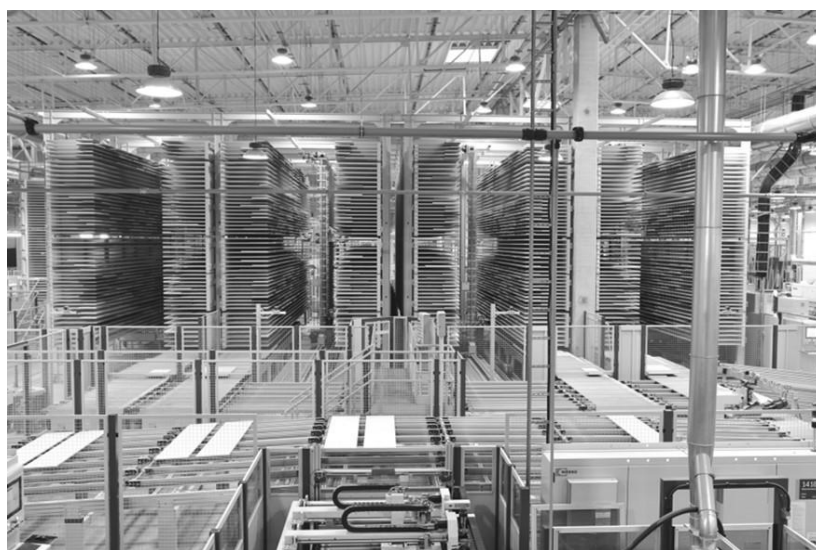
Rys. 3. Linia produkcyjna w Fabryce Mebli Biurowych Nowy Styl w Jasło, w głębi widoczny bufor-sorter Fig. 3. Production line at the Nowy Styl Office Furniture Factory in Jasło, with a buffer-sorter visible in the background
