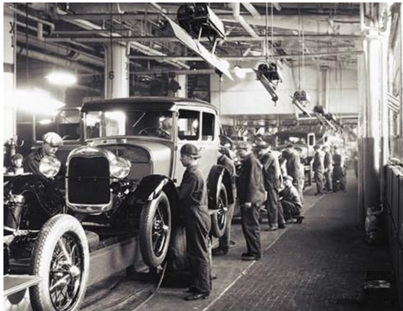
Rys. 2. Taśma montażu samochodów w fabryce Forda w 1927 roku ( http://retopress.pl/tag/ford/ ) Fig. 2. Car assembly line at the Ford factory in 1927 ( http://retopress.pl/tag/ford/ )
